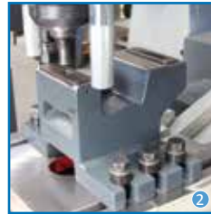
IPN/UPN ve Köşebent delme kalıbı IPN/UPN and angle punching tool Приспособление для пробивки IPN/UPN urolka
