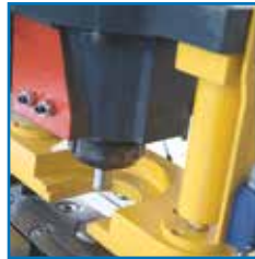
Hidrolik sıyrıcı sistemi Hydraulic stripper Гидравлический съемник
