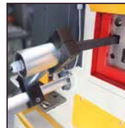
Elektrikli arka dayama (Cift pistonda standart) Electrical back gauge (Standard in double pistons) Электронный задний упор для настройки размера резки (стандартно для 2-х поршневых)
